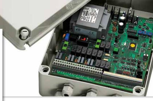
Различные приемники телеметрических сигналов были разработаны для дистанционного управления уличными поворотными устройствами. Ассортимент приемников включает модели как в базовой, так и в наиболее полной комплектации, которые обеспечивают управление функциями поворотных устройств и объективами с приводом.
