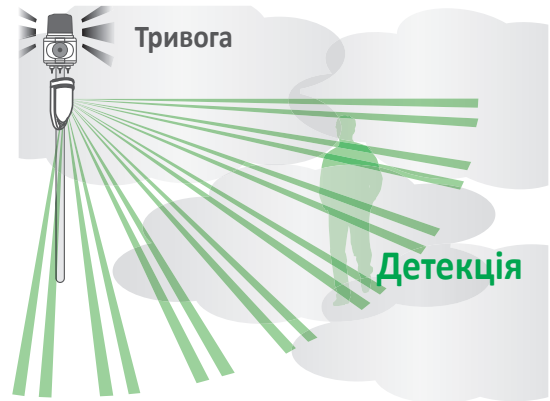
Пасивний сенсор детектує порушника
